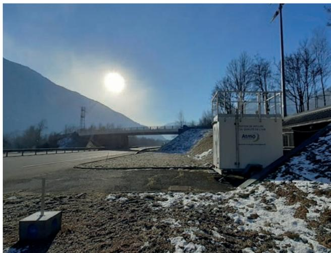
Les 2 stations de mesures sont équipées de capteurs permettant de mesurer les concentrations en particules fines ainsi qu'en oxydes d'azote (deux polluants émis par les véhicules en circulation), et de systèmes de télétransmission de ces données. ATMO assure la maintenance des installations, ainsi que la collecte et l'analyse des mesures. Les données sont ensuite mises à disposition du public sur leur site internet. ATMO produira également un
